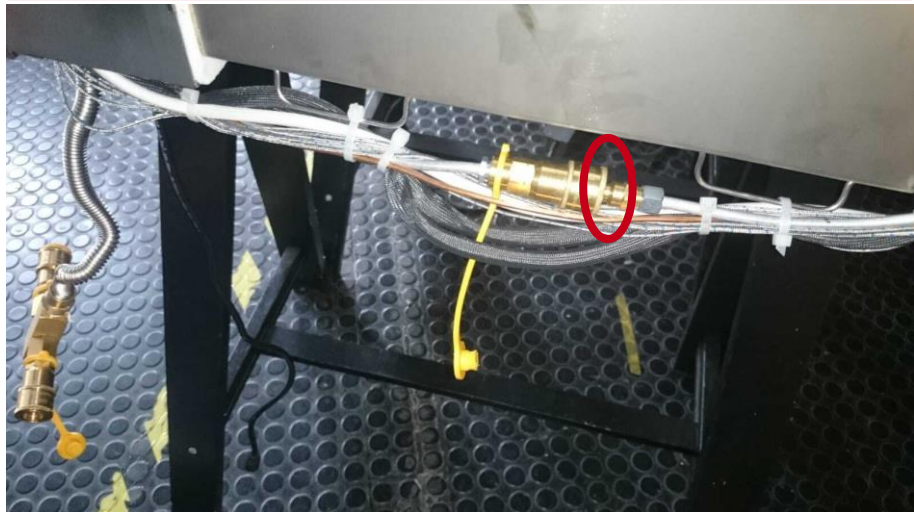
Quick-Connect gelöst (kleiner Spalt)
