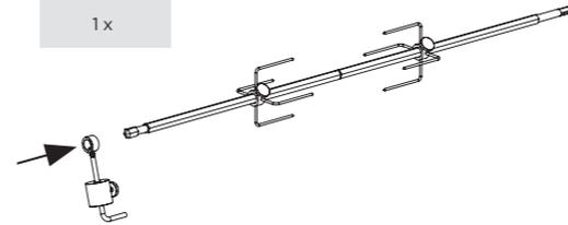
Durch die Verwendung eines Gegengewichts wird sichergestellt, dass die Last gleichmäßig auf den Spieß verteilt wird und es zu keinem Zeitpunkt des Garvorgangs zu einer Überlastung des Motors kommt.
