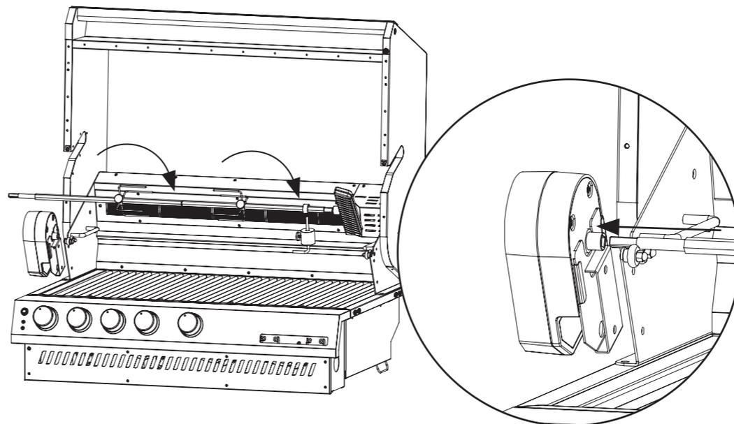
! Das maximale Beladungsgewicht des Motors beträgt 16 kg. Der maximale Durchmesser für Grillgut beträgt 30 cm.
