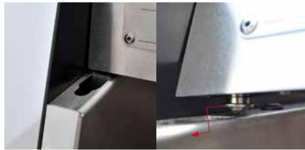
Schiebe nun das Oberteil langsam nach vorne bis die beiden nach unten hervorstehenden Zapfen des Oberteils in die Schlüssellochförmigen Vertiefung fallen.
